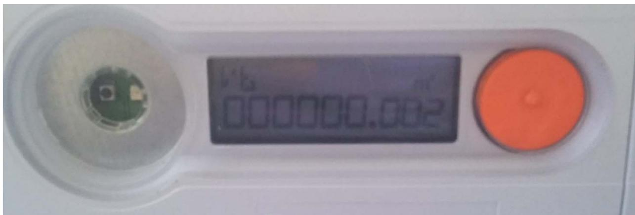
Come si può notare dall'immagine, nella riga superiore appare la scritta Vb e nella riga inferiore il valore del totalizzatore espresso in metri cubi con 6 cifre e 3 decimali dopo il punto.
