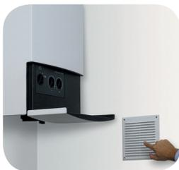
Los aparatos de cocción y los aparatos para producir agua caliente (calentadores) y calefacción (calderas o estufas) que utilizan el aire presente en el local, definidos aparatos de tipo A y B, siempre requieren una abertura de ventilación para garantizar un aporte continuo del aire necesario para la combustión en la habitación donde están instalados.
