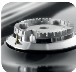
Riteniamo la presenza dei dispositivi di sicurezza nel piano cottura un elemento imprescindibile e determinante ai fini della sicurezza domestica. Tale dispositivo ha lo scopo di bloccare l'emissione del gas nel momento in cui si dovesse verificare uno spegnimento accidentale della fiamma, grazie ad un sensore posto sul bruciatore.
