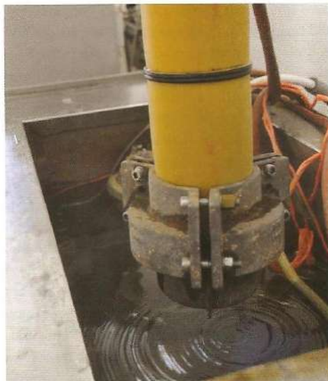
Foto 1. Test di trazione su giunzione testa-testa tubo multistrato
